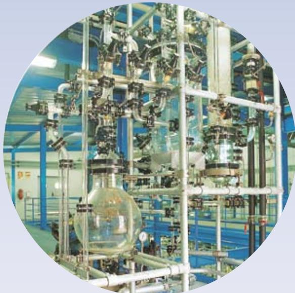
Производство новых продуктов основано на предварительной лабораторной разработке с последующей апробацией на pilotной установке, представляющей из себя гибкую многоцелевую синтетическую линию, позволяющую максимально оптимизировать условия крупномасштабного синтеза целевого продукта.
